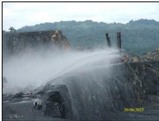
ภาพที่ 2.23 การฉีดน้ำดับฝุ่นขณะทำการระเบิด ด้วยหัวฉีด Twin Comet
