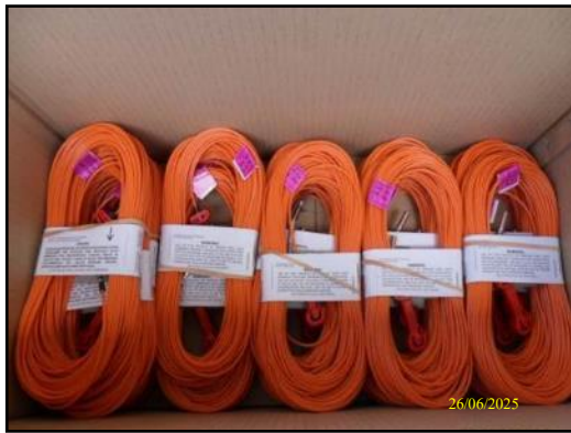
ภาพที่ 2.18 การใช้แถบห่วงเวลาเพื่อควบคุมปริมาณวัตถุระเบิดต่อจังหวัดการระเบิด ให้มีค่าน้อยกว่า 650 กิโลกรัม/จังหวัดถ่วง
